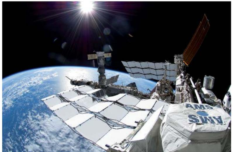
**Fig. 8.** Espectrómetro Magnético Alpha (AMS-02), detector de rayos cósmicos instalado en la Estación Espacial Internacional. (Fotografía cortesía de la NASA).
